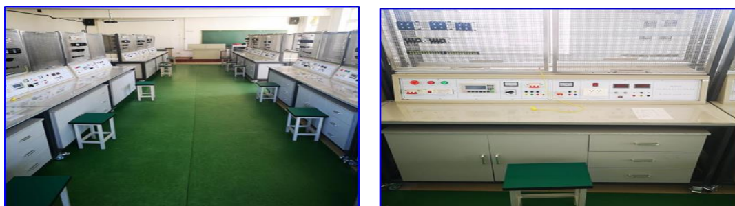
图 8-9 电工实训室、XK-ETT1 型网孔型维修电工实训考核装置
